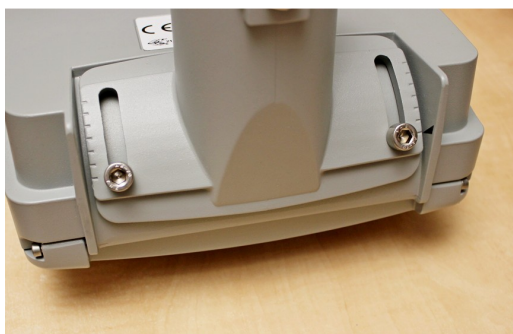
Obr.3 Montáž na stožár, elevace 0°
